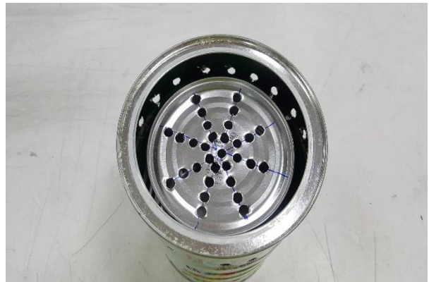
進氣孔略高於小鐵罐底部
