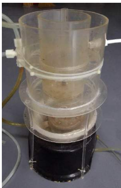
圖三、簡易型污水處理設備
