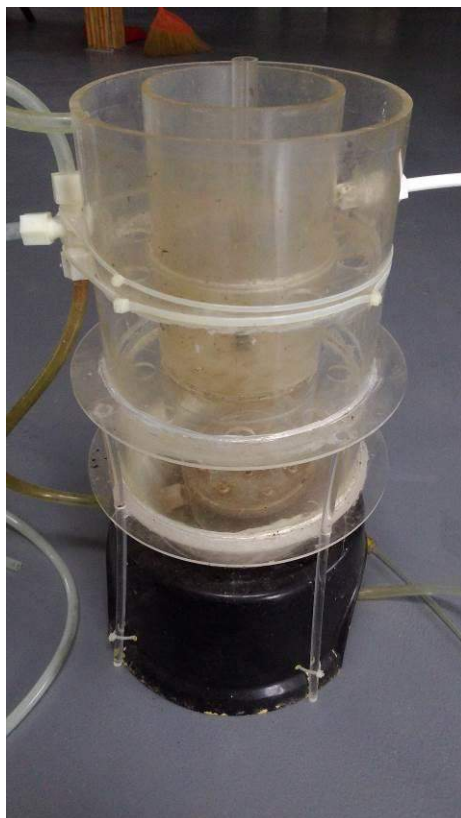
圖三、簡易型污水處理設備
