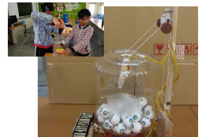
5.製作原型：用4.5V 電池盒控制攪拌盤、電池鐵、抓取器。
