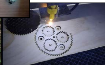
6.迭代完善—齒輪比1:3 的木製車架可在草上前進，且可以爬坡度約10度的坡面。改寫程式。
