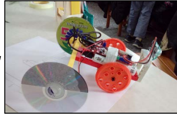
2.設計探索：加上預計的智能晶片、電池及感測器(沒有功能只是預估重量)在平地可以前進
