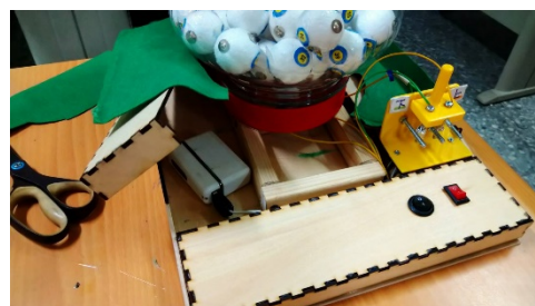
6.迭代完善—3D 建模、3D 列印轉向控制盒、改裝 USB 線，換成行動電源。
