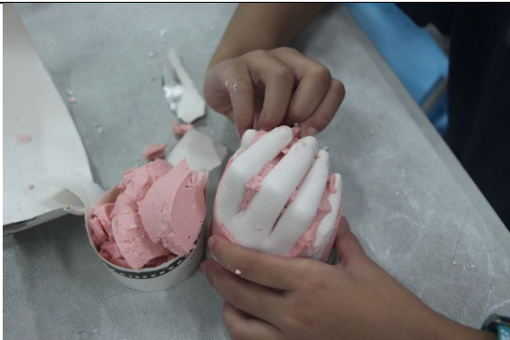
3. 灌入石膏硬化後拆掉海藻模
