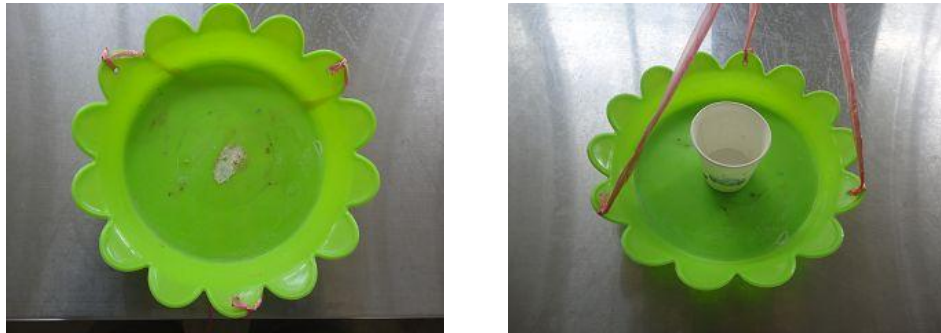
圖十二、甩水杯實驗裝置圖
