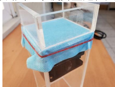
上方增加一節壓克力並固定
