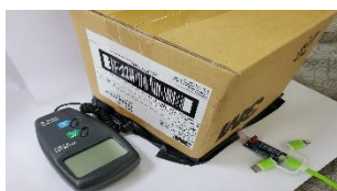
黑膠帶密封孔隙預防走光
