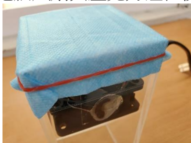
以橡皮筋初步固定口罩
