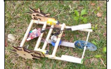
5.發展原型：將車架換成木條，前輪由雙輪換成單輪(光碟片)，拆解指尖陀螺的軸承加入光碟片中，使運轉更滑順。
