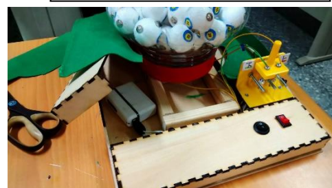
6.迭代修正—3D 建模、3D 列印轉向控制盒、改裝 USB 線，換成行動電源。
