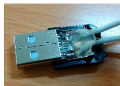
6.迭代修正—3D 建模、3D 列印轉向控制盒、改裝 USB 線，換成行動電源。
