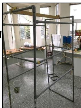
4.規劃探索：雷切帶動滾輪並裝在 TT 馬達上，組裝水管曬衣架。利用滑輪進行升降測試。
