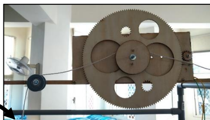
6.迭代修正—3D 建模、3D 列印腳座、減速齒輪、加上紅外線感應、水滴感應器。
