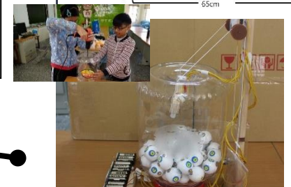
5.發展原型：用 4.5V 電池盒控制攪拌盤、電池鐵、抓取器。
