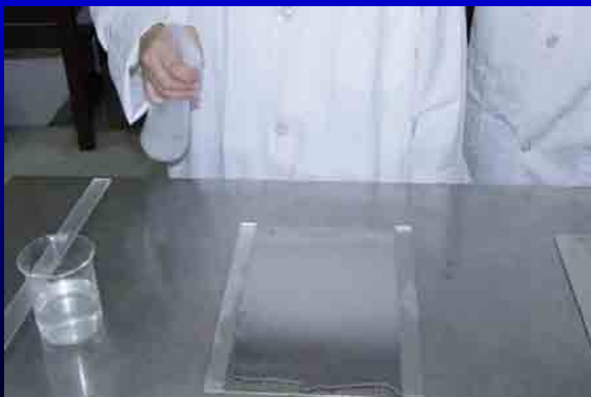
海藻膠糊液表面進行氯化鈣溶液噴霧
