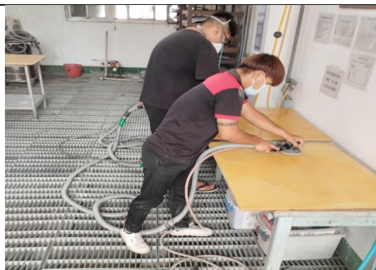
圖21.噴漆完磨光表層以達琉璃質感
