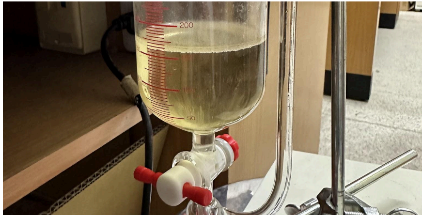
圖3-1 精油與水分層之圖示
