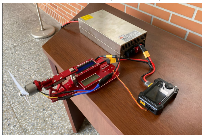
圖七:以馬達拉力計固定於桌面進行量測
