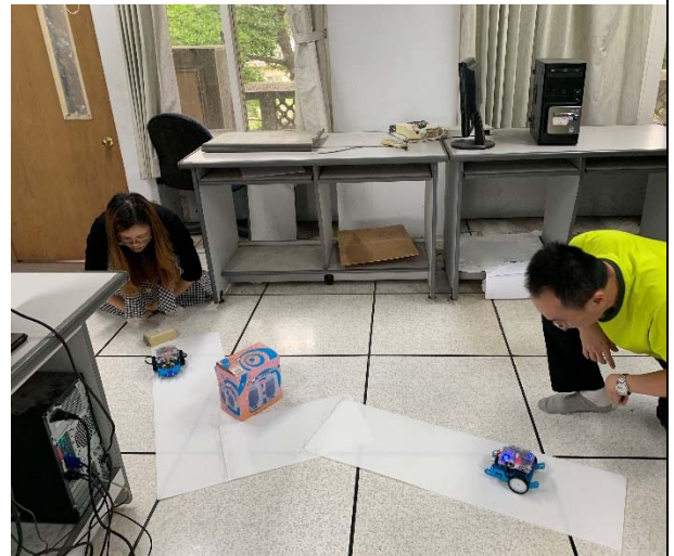
循著既定的軌道前進-全部的路程有三段、兩次轉彎，要控制機器人轉彎的角度和速度能順利到達終點
