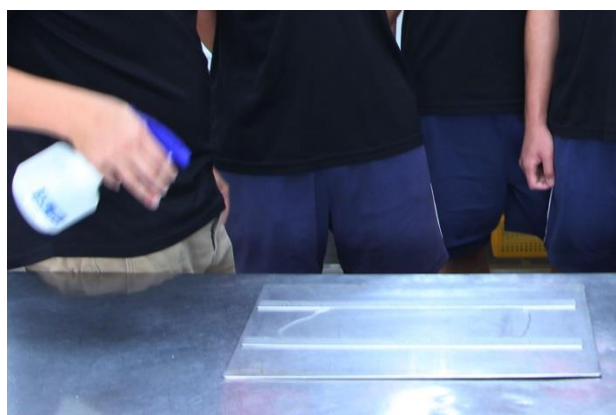
C.將氯化鈣溶液微噴到海藻酸鈉表面
