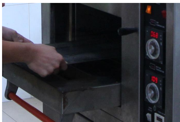
B.進行熱風乾燥使糊液凝膠形成薄膜
