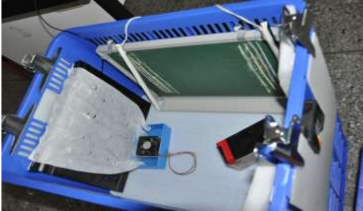
Pic.15：將鋁箔貼在黑色的 PP 板，可反射陽光的輻射，中空的 PP 板可使熱向上對流排出，比保麗龍更薄，隔熱效果更好。
