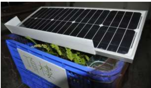
Pic.13：我們用2層「蔬果箱」當作頂樓與5樓教室模型，使用單晶太陽能板、黑紗網、綠色植栽、可回收雨水的「水撲滿」裝設上層蔬果箱；PP板、過濾棉、鋁箔紙裝設下層蔬果箱，可防止陽光的熱傳導、對流、輻射，使箱內溫度降溫。
