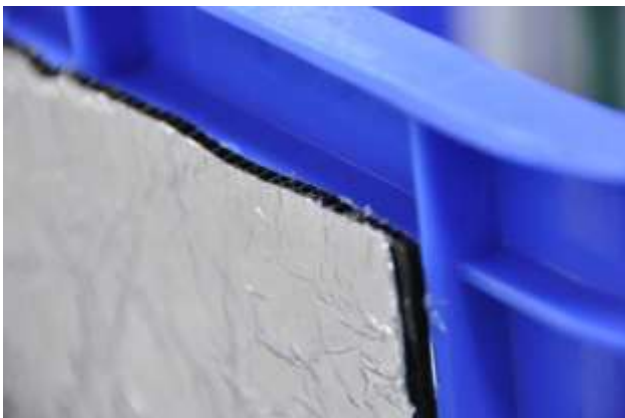
Pic.15：將鋁箔貼在黑色的 PP 板，可反射陽光的輻射，中空的 PP 板可使熱向上對流排出，比保麗龍更薄，隔熱效果更好。
