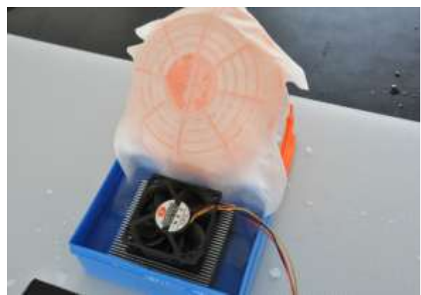
Pic.16：透氣的不織布利用毛細現象吸水，罩在橘色風扇，鋁合金散熱片與水熱接觸，風扇可加速水蒸發，降低教室溫度。
