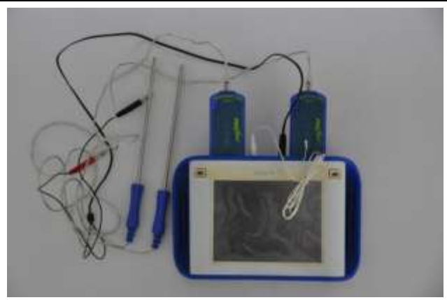
Pic.18：Pasco 數位主機連接 3 組溫度感應器，可同時測量箱內實驗組、對照組、戶外的溫度。
